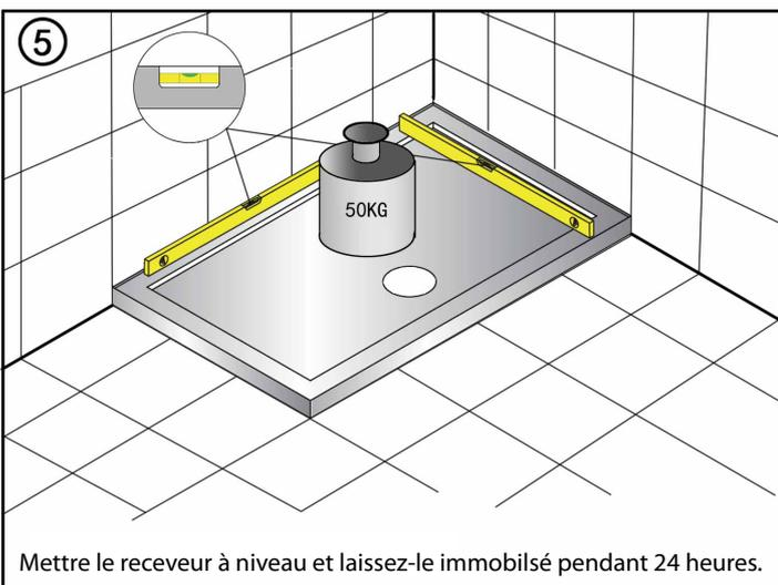
Mettre le receveur à niveau et laissez-le immobilisé pendant 24 heures.
