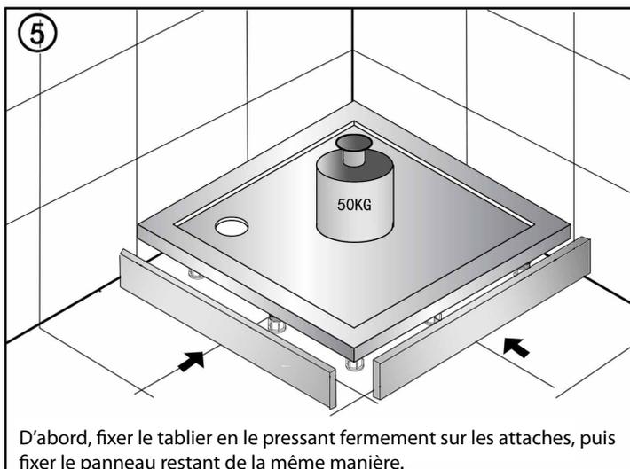
D'abord, fixer le tablier en le pressant fermement sur les attaches, puis fixer le panneau restant de la même manière.
