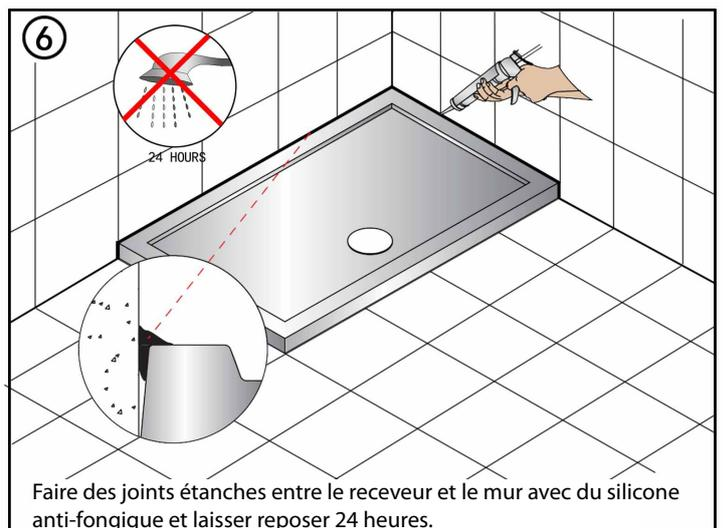
Faire des joints étanches entre le receveur et le mur avec du silicone anti-fongique et laisser reposer 24 heures.
