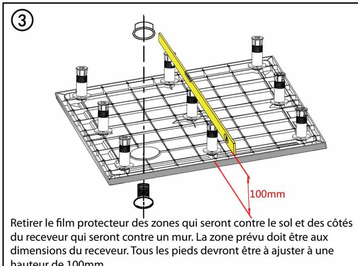
Retirer le film protecteur des zones qui seront contre le sol et des côtés du receveur qui seront contre un mur. La zone prévu doit être aux dimensions du receveur. Tous les pieds devront être à ajuster à une hauteur de 100mm.
