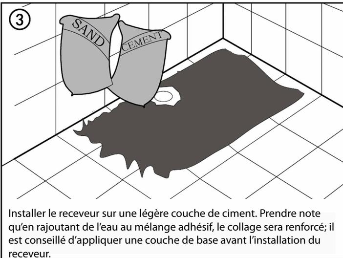
Installer le receveur sur une légère couche de ciment. Prendre note qu'en rajoutant de l'eau au mélange adhésif, le collage sera renforcé; il est conseillé d'appliquer une couche de base avant l'installation du receveur.
