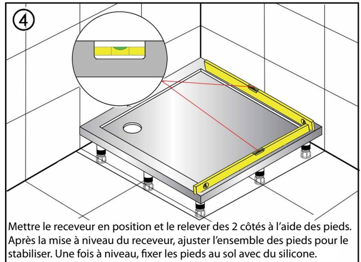
Mettre le receveur en position et le relever des 2 côtés à l'aide des pieds. Après la mise à niveau du receveur, ajuster l'ensemble des pieds pour le stabiliser. Une fois à niveau, fixer les pieds au sol avec du silicone.
