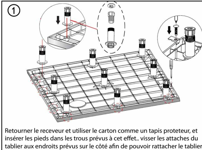
Retourner le receveur et utiliser le carton comme un tapis protecteur, et insérer les pieds dans les trous prévus à cet effet.. visser les attaches du tablier aux endroits prévus sur le côté afin de pouvoir rattacher le tablier.
