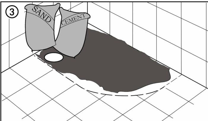
Installer le receveur sur une légère couche de ciment. Prendre note qu'en rajoutant de l'eau au mélange adhésif, le collage sera renforcé; il est conseillé d'appliquer une couche de base avant l'installation du receveur.
