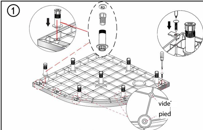
Retourner le receveur et utiliser le carton comme un tapis protecteur, et insérer les pieds dans les trous prévus à cet effet.. visser les attaches du tablier aux endroits prévus sur le côté afin de pouvoir rattacher le tablier.
