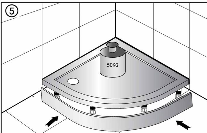
D'abord, fixer le tablier en le pressant fermement sur les attaches, puis fixer le panneau restant de la même manière.
