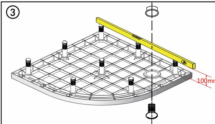
Retirer le film protecteur des zones qui seront contre le sol et des côtés du receveur qui seront contre un mur. La zone prévu doit être aux dimensions du receveur. Tous les pieds devront être à ajuster à une hauteur de 100mm.
