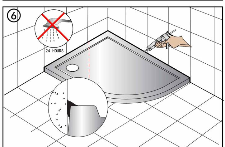
Faire des joints étanches entre le receveur et le mur avec du silicone anti-fongique et laisser reposer 24 heures.
