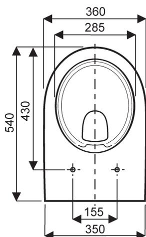
Fixation : par boulons sur mur porteur ou bâti support.
